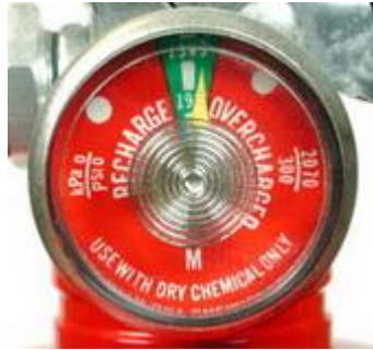
ภาพ Pressure Gauge ของถังดับเพลิง พร้อมใช้งาน (เข็มสีเขียวอยู่ในพื้นที่สีเขียว)
